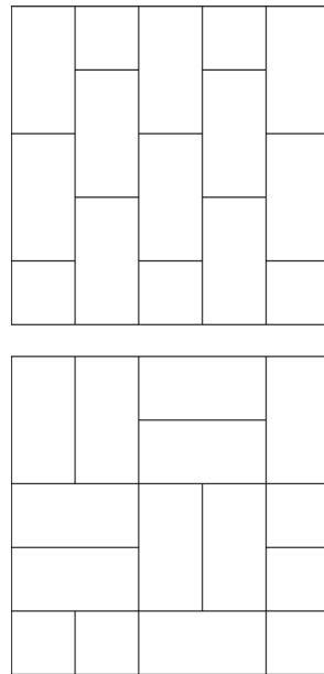
Betonski element namenjen za uređenje i izgradnju pešačkih staza i puteva. Vrlo je dekorativan za uređenje ulica i centara naseljenih mesta, parkova, šetališta, dvorišta i terasa. Izrađuje se u više boja, a zbog jednostavnosti uklapanja pruža mogućnost velikog broja različitih kombinacija.
