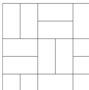
Betonski element namenjen za uređenje i izgradnju pešačkih staza i puteva. Vrlo je dekorativan za uređenje ulica i centara naseljenih mesta, parkova, šetališta, dvorišta i terasa. Izrađuje se u više boja, a zbog jednostavnosti uklapanja pruža mogućnost velikog broja različitih kombinacija.
