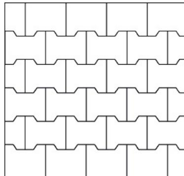
Osnovna karakteristika ovog modela je odličan sistem uklapanja jedinica, kod koga jednu pločicu opšivaju četiri bočne čime se postiže izuzetna stabilnost popločane površine. Lakoća postavljanja, velika funkcionalnost, dugotrajnost i osećaj udobnosti pri korišćenju, čine ga idealnim za popločavanje površina sa frekvenitim saobraćajem, kako pešačkim tako i motornim. Debljina od 6 cm koristi se sa pešačke zone i lakši saobraćaj, a 8 cm za teški teretni saobraćaj.
