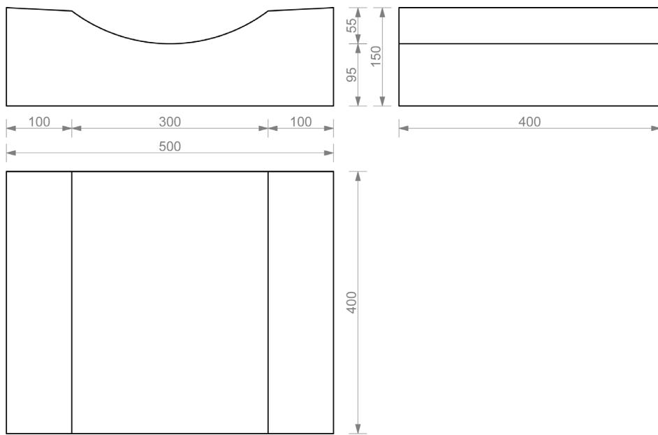
Element je namenjen za odvod atmosferskih plitkih voda pri izradi i uređenju saobraćajnica, puteva, parking prostora, dvorišta, terasa, kao i drugih građevinskih površina.
