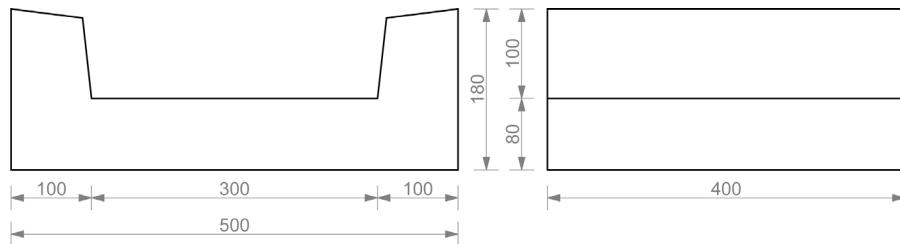
Element je namenjen za odvod atmosferskih plitkih voda pri izradi i uređenju saobraćajnica, puteva, parking prostora, dvorišta, terasa, kao i drugih građevinskih površina.
